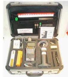
**13. RapiCor (钢筋腐蚀速测仪)****产地:** 丹麦**用途:** 钢筋腐蚀; 腐蚀速度, 钢筋半电池电位与混凝土电阻**特性:** 用于测量混凝土中钢筋腐蚀快慢, 其典型应用包括:
