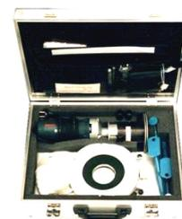
**3. RAT 快速碱含量测试****产地:** 丹麦**用途:** 耐久性/ 碱骨料反应; 新制混凝土碱含量**特性:** 用于测量砂浆中碱骨料反应所需的钠和钾离子的含量。
