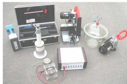
**2. PROFILE GRINDER 成型器****产地:** 丹麦**标准:** ASTM C1556 NT BUILD 443**用途:** 耐久性/ 使用寿命评估; 氯离子扩散系数的现场及实验室实验**特性:** 用于打磨混凝土表面, 用获得的混凝土粉末来测量氯离子的分布。
