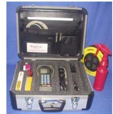
**14. ICAR 流变仪****产地:** 丹麦**用途:** 测量从低塌落度到自固混凝土**特性:** \* 可控速率, 四片装叶轮, 高 125 mm, 直径 125 mm
