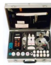
**11. 深紫和彩色指示剂****产地:** 丹麦**用途:** 钢筋腐蚀; 混凝土碳化层深度**特性:** 用于在现场测定混凝土的碳化深度。测量碳化深度有以下用途:
